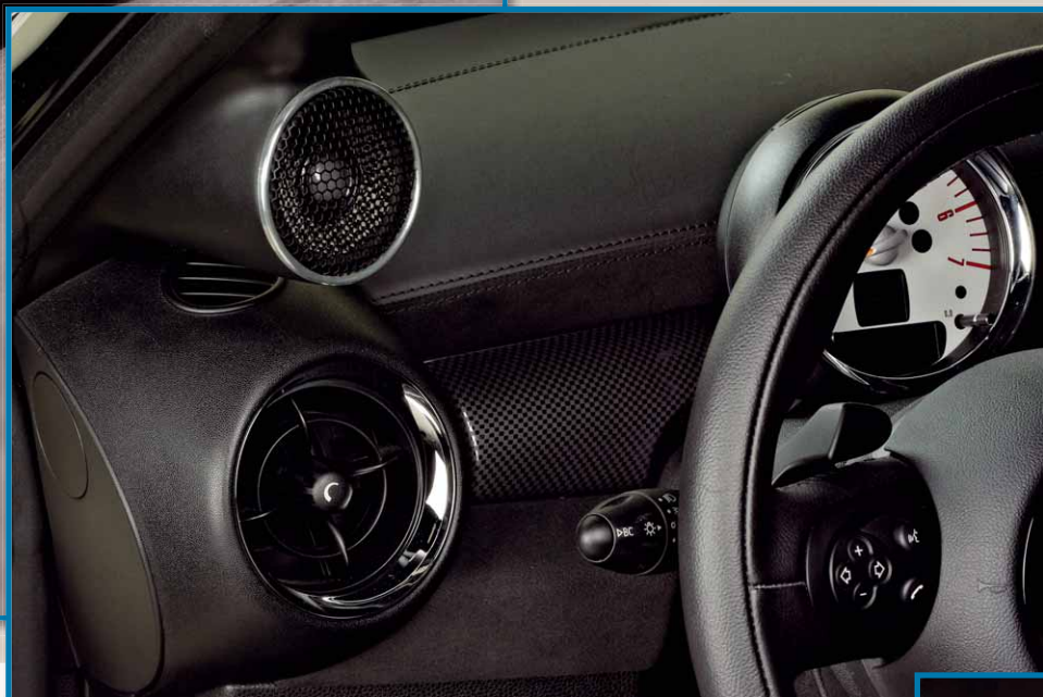
Die 3-Zoll-Koinzidenzwandler wurden in den umgebauten A-Säulen asymmetrisch auf den Fahrer hin ausgerichtet
