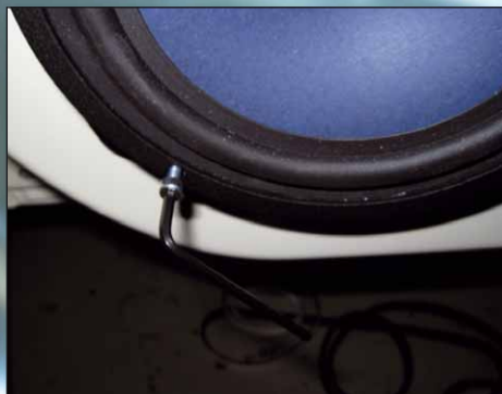
Wichtig: Fester Halt für die Chassis in den gefrästeten MDF-Ringen
